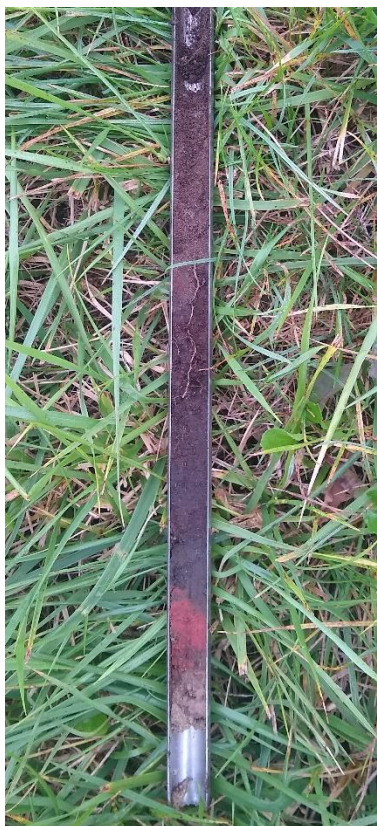
Figuur 4. Boring 50, met een opvallend rood niveau van sideriet in de basis van de beekleem op het dekzand.
